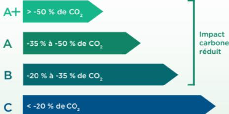
Nos bétons sont identifiés dans un référentiel avec 4 classes de réduction d'émission de CO<sub>2</sub>
