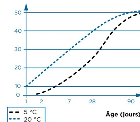
Si à 20 °C, la résistance en compression d'un béton courant est d'environ 15 MPa à 2 jours, elle tombe à 2 MPa quand la température extérieure est comprise entre 0 °C et 5 °C.
