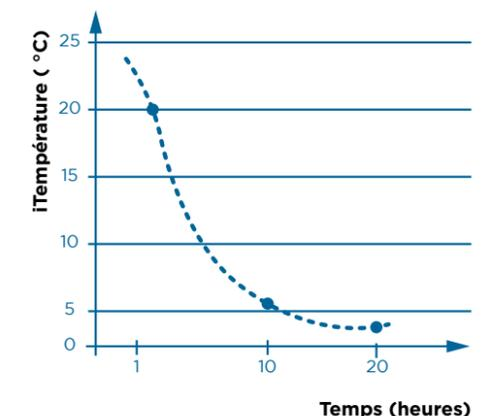
Le temps de prise d'un béton courant, qui est de 2h30 à 20 °C, s'allonge d'environ 10h00 à 5 °C.
