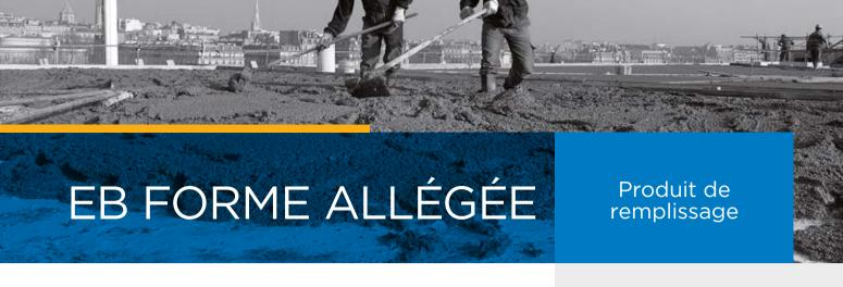
BÉTON LÉGER NON STRUCTUREL POUR LA RÉALISATION DE RAVOIRAGE ET DES FORMES DE PENTES
